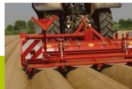
Mit der Dammschneidemaschine wird die Erde nach der Kartoffel Saat verfeinert und zu einem Damm geformt.
